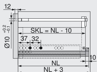
\*\* Ограничение регулировки по ширине при толщине боковины ящика 16 мм и соответственно при полном использовании внутренней ширины ящика.
