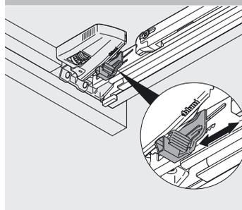
Регулировка по высоте: + 3 мм
