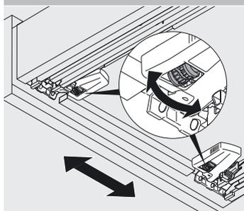
Регулировка по ширине на обоих замках: +/- 1,5 мм\*
