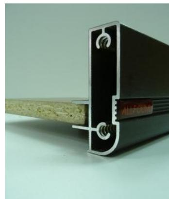
Приставив к торцам фасадных профилей продольные С-профили, соединить детали в рамку, вкручивая саморезы через подготовленные отверстия продольного С-профиля в тело фасадного профиля. Установить заглушки с передней стороны рамки.
