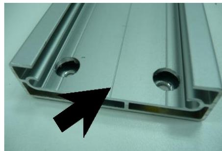
3. В случае сборки рамки под полку для обуви, разметить отверстия под саморезы для установки стандартных обувниц. Отверливать необходимо только одну стенку полого профиля – не сверлить насквозь!!! Отверстия размечаются на крайних разметочных рисках, размещенных вдоль профиля на гладкой внутренней стороне С-профиля (см схему 6, 7), причем под переднюю обувницу отверстия должны находиться на верхней разметочной риске, под дальнюю — на нижней:
